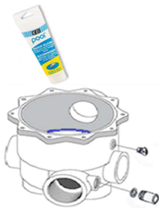
Afbeelding 8 - Smering van de afdichting en de klep
